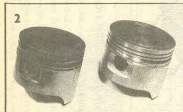
Изношенный (слева) и заново изготовленный поршни. Новый поршень на 15 г тяжелее.
